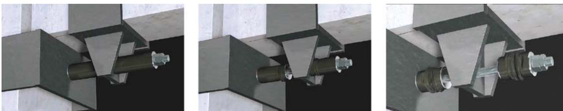
*Figura 2- Sequenza di funzionamento dei dispositivi durante l'azione sismica*
